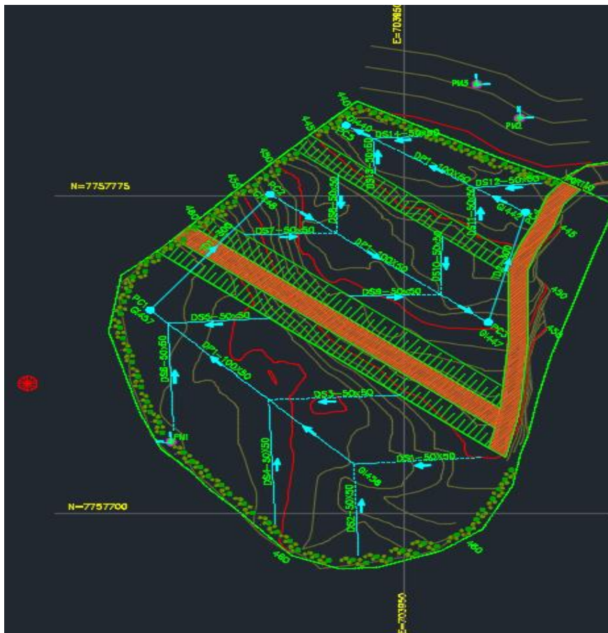
Figura-1: Sistema de drenagem de chorume
